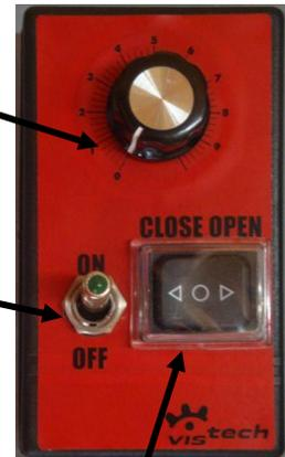
Mit dem „< >“ Wipp-Schalter wird der Schieber geöffnet bzw. geschlossen.
