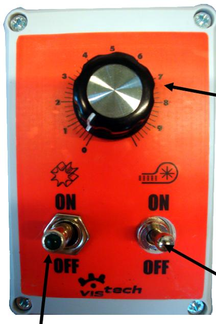
Potentiometer: Drehzahleinstellung der Säwelle
