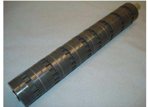
**Tipp!** Durch **blinde Säräder** kann die Ausbringmenge noch wesentlich reduziert werden.
